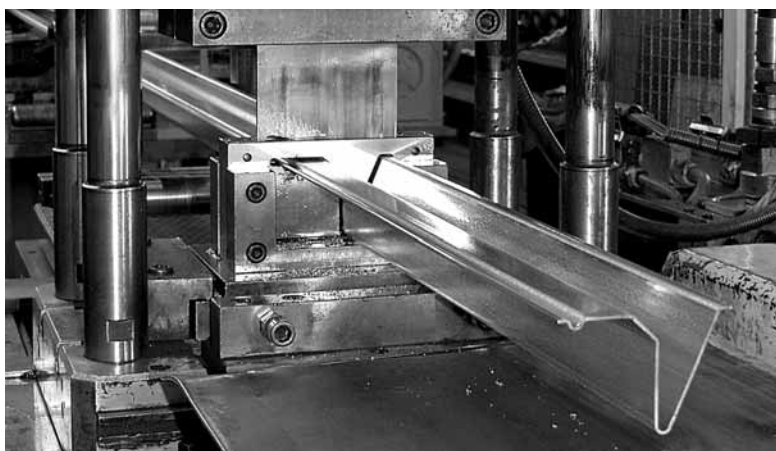
Dalle bobine di laminato d'acciaio al profilato finito. Sistemi di produzione supermoderni formano il profilato speciale HS – qui un supporto per pallet ad innesto rapido 'Snap-in'
