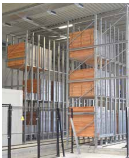
Brett-pufferregal zur Lagerung der Produktionsbretter
